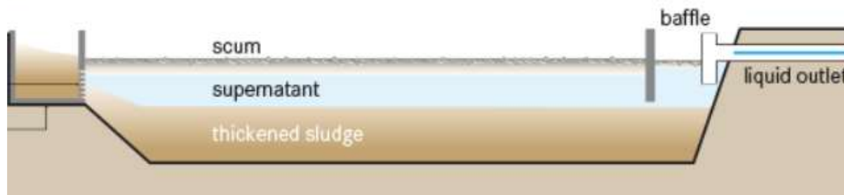
Settling pond (SP) Ülepítő tó (anaerob)
